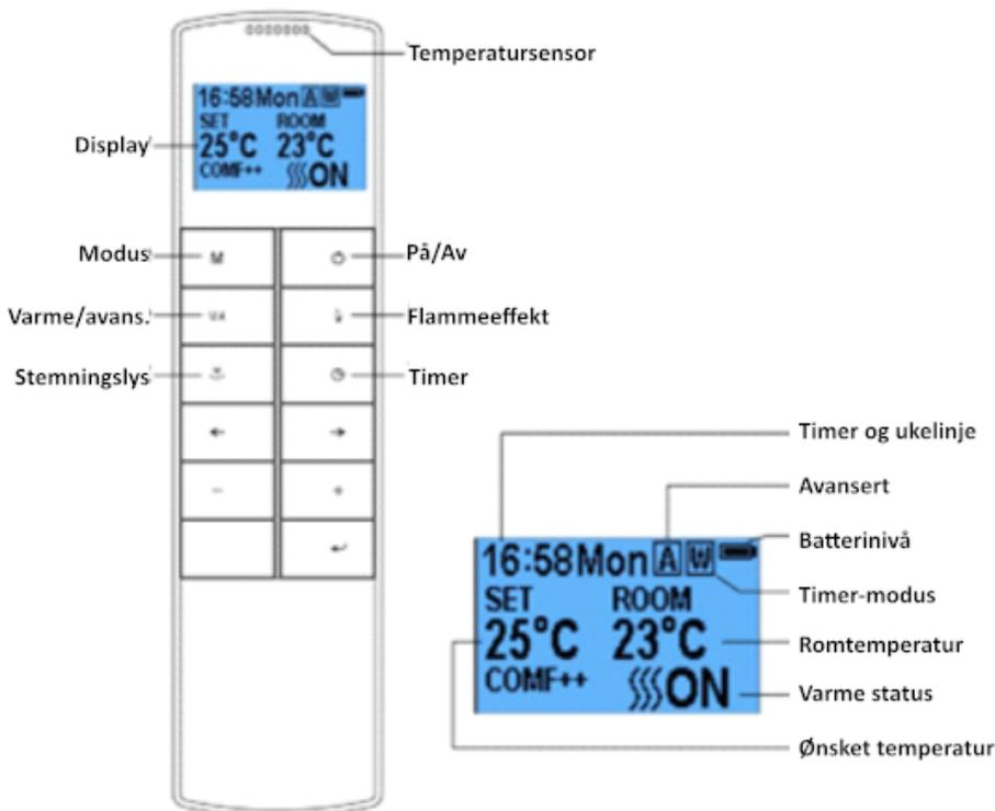
**MERK:** Dette er en termostatisk fjernkontroll. Fjernkontrollen bør være i samme rom som peisen og plasseres på et flatt underlag. Den registrerer romtemperaturen, så den må ikke plasseres i en posisjon som lar apparatets varmluft blåse på den og påvirke termostatavlesningen.
