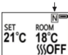
OBS: Det er normalt at varmeviften slutter å gå i perioder. Dette skjer fordi romtemperaturen er på eller over temperaturen som er stilt inn på fjernkontrollen.
